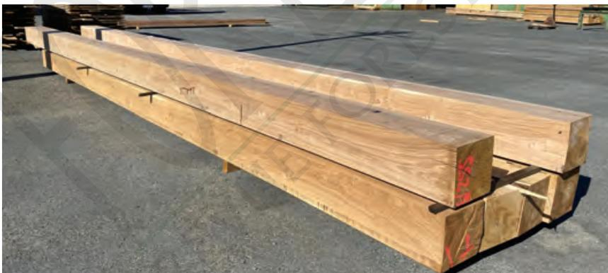
Pièces de charpente de 10 m en 280 mm x 280 mm.
